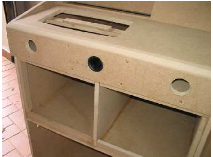
Für die Belüftung im oberen Boxenbereich werden drei Löcher gesägt.
