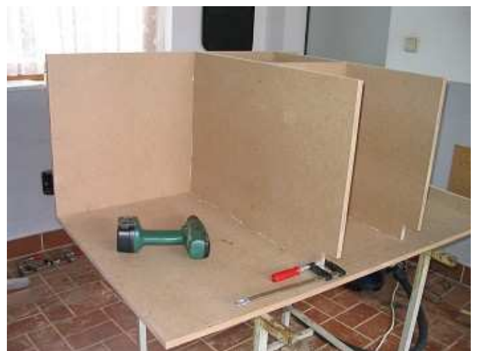
nun alle Teile in der richtigen Reihenfolge zusammenleimen und verschrauben.
