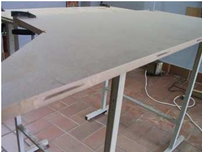
Hier die Frässtellen an der Kopfseite einer Platte
