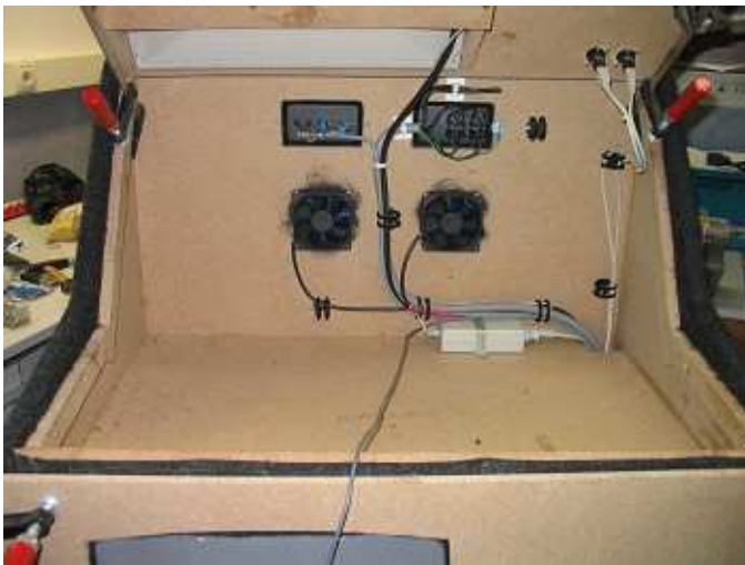
Im oberen Teil der Musikbox wurden zwei Lüfter und das Netzteil für den TFT untergebracht, sowie
