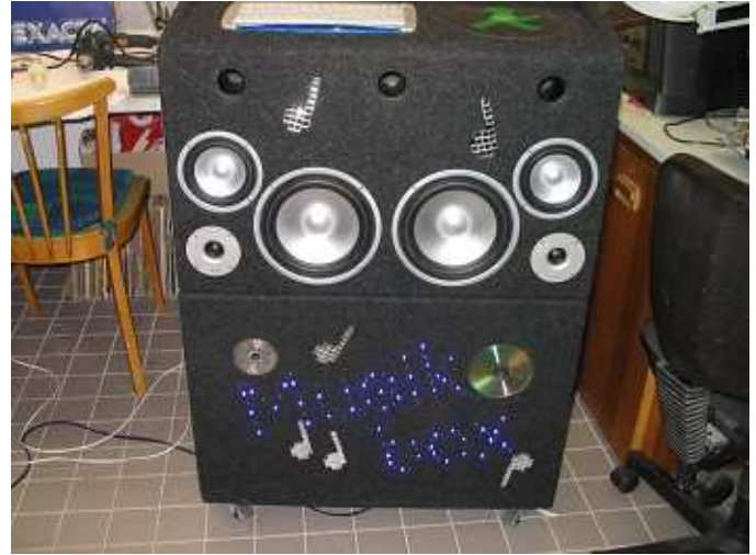
Die Tür wurde mit Klavierband befestigt und wird durch Magnete verschlossen.
