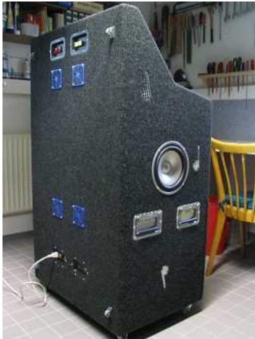
Und so sieht das Ganze von der Seite aus. Auf der Rückseite wurden noch 4 Rollen montiert, um die Box besser in meinen Kombi schieben zu können.
