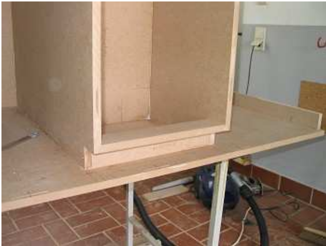
Hier ist der Kabelschacht durch die Lautsprecherbox zu erkennen.
