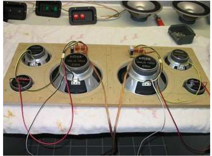
...wird die Frontplatte mit den Lautsprechern bestückt.
