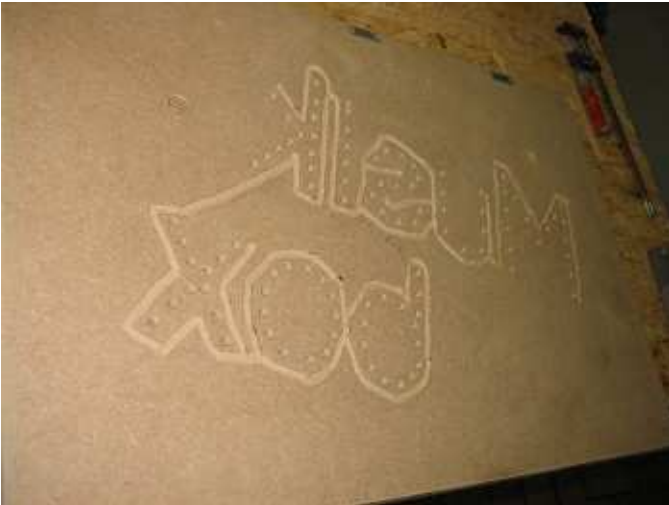
Um die Verdrahtung unterzubringen wurde in die Rückseite eine Nut gefräst.
