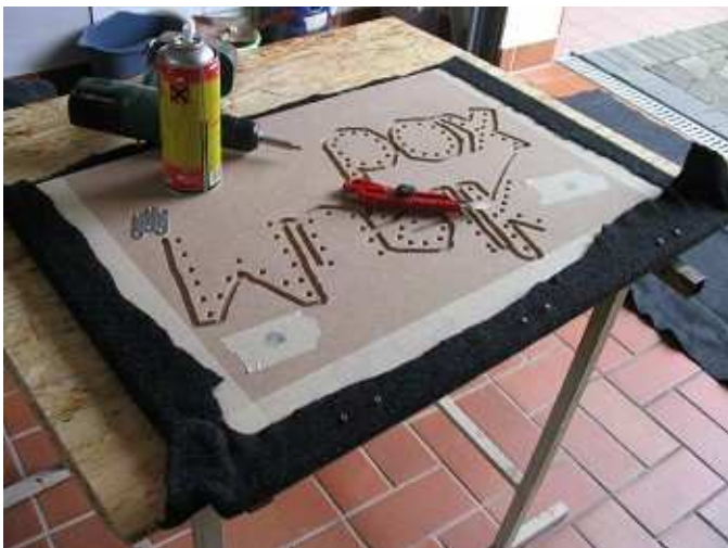
Mit Cutter und Sprühkleber wurde der Filz...
