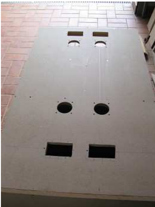
Auf der Rückseite werden die Ausschnitte für die Anschlussplatten und Lüfter gesägt.
