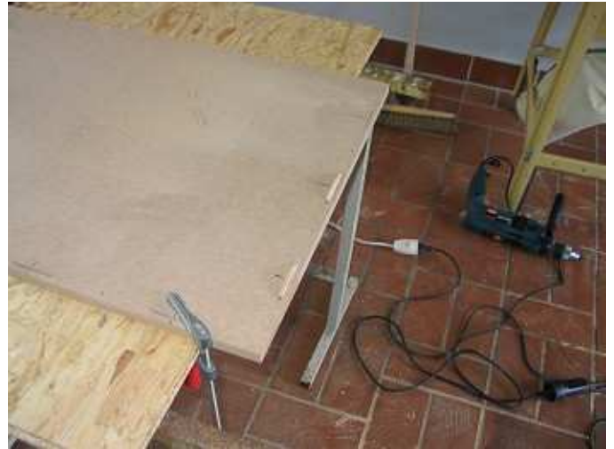
Mit der Fräse werden die Nuten für die "Lamellos" in die Platten gefräst.
