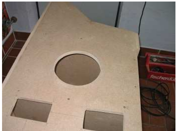
Wegen der geringen Fläche für die Lautsprecher wurden die Basslautsprecher in zwei Paare geteilt
