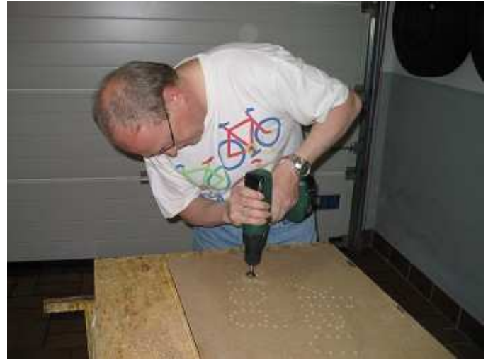
Danach wurden alle Löcher entgradet.
