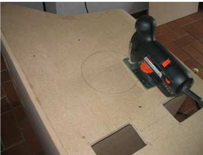
Oberhalb der Tragegriffe entsteht noch eine Öffnung für einen der vier Basslautsprecher
