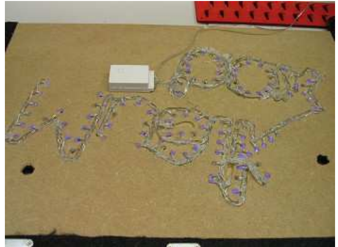
Anschließend wurden alle LED und Kabel in die Entsprechenden Öffnungen geklebt.
